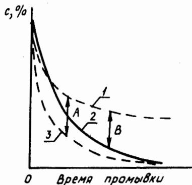
Рис. 14. Типичная зависимость концентрации \bar{c} маточного вещества в жидкости от времени промывки: 1 — концентрация в жидкости осадка фильтр-пресса; 2 — концентрация в фильтрате или в жидкости осадка фильтра Artisan; 3 — концентрация в фильтрате фильтр-пресса
